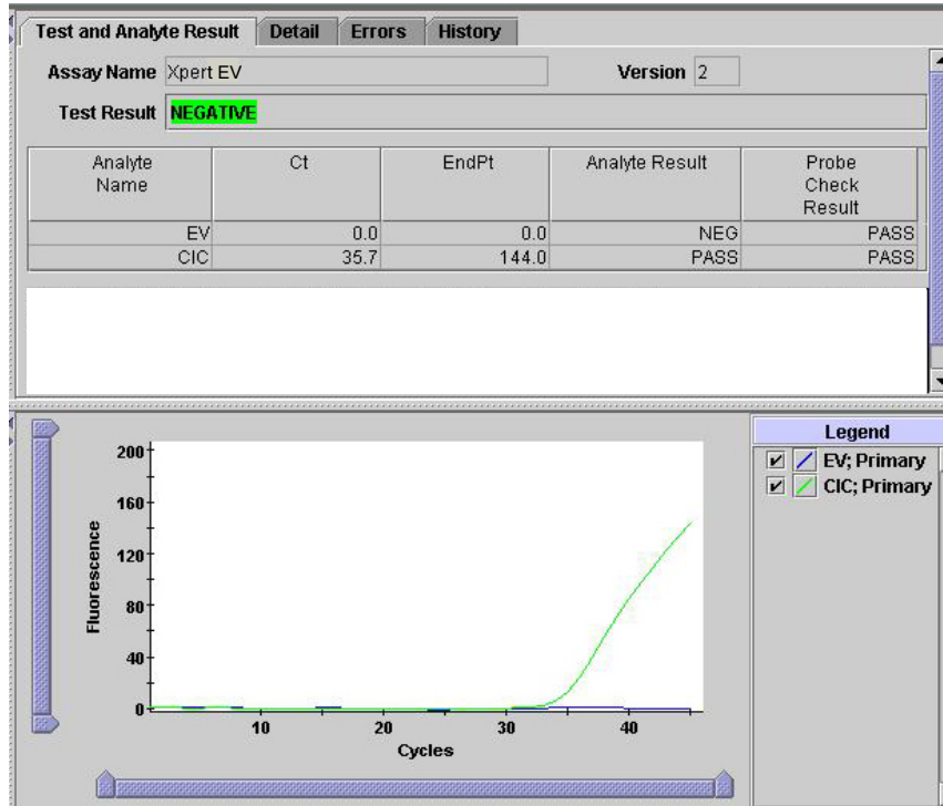
Figure 3. Risultato negativo (finestra GeneXpert® Dx System - View Results (Visualizza risultati), l'SPC/IC è visualizzato come CIC)
