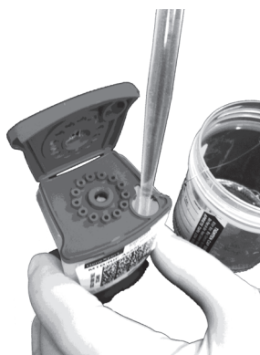
Figura 5. Distribua a amostra liquefeita descontaminada na câmara da amostra do cartucho
